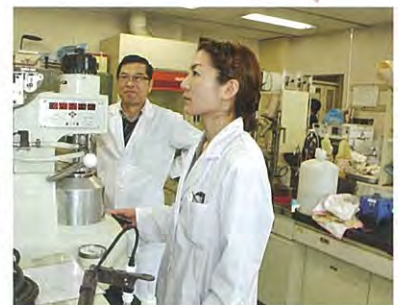
瀬口正晴教授(左)とともにブラベンダーアミノグラフで小麦粉の粘度を計測中
